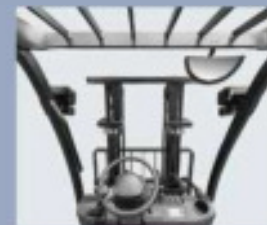
El mástil de nuevo diseño y el gran techo de acero abierto proporcionan una excelente visibilidad; también pueden reducir el riesgo de accidentes
